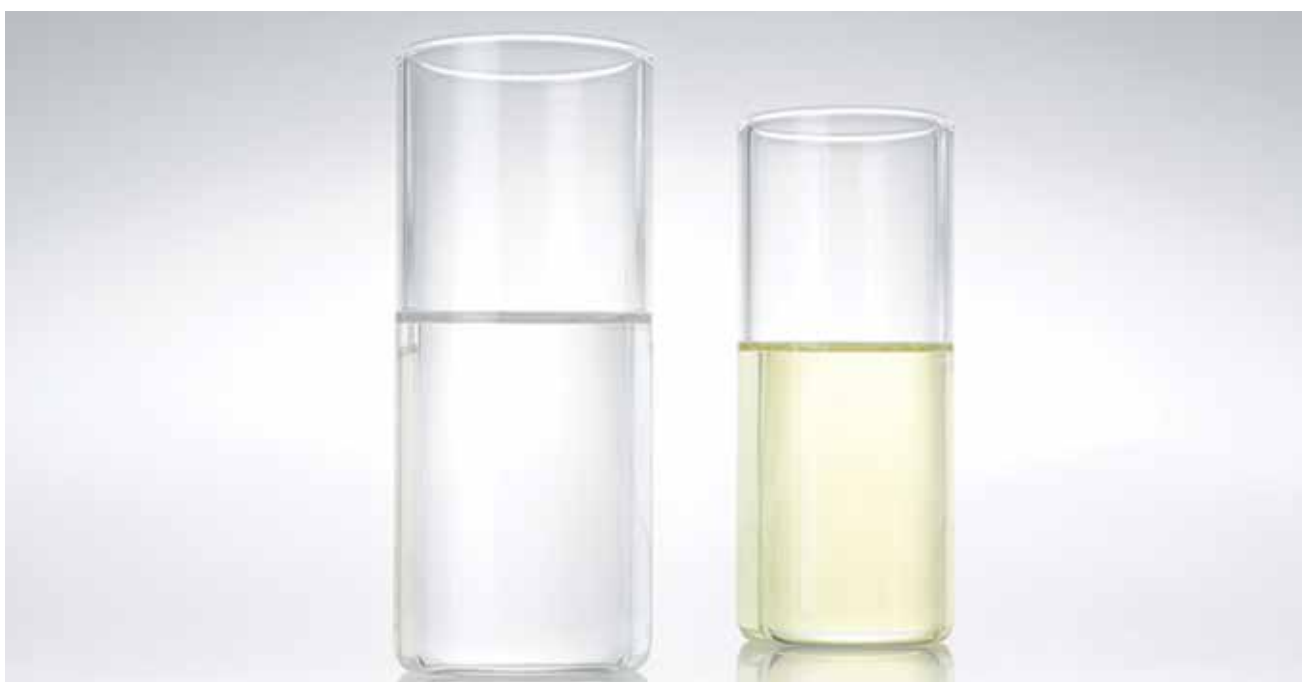
KLEURVERGEELIJING GTL (LINKS) EN DIESEL (RECHTS)
