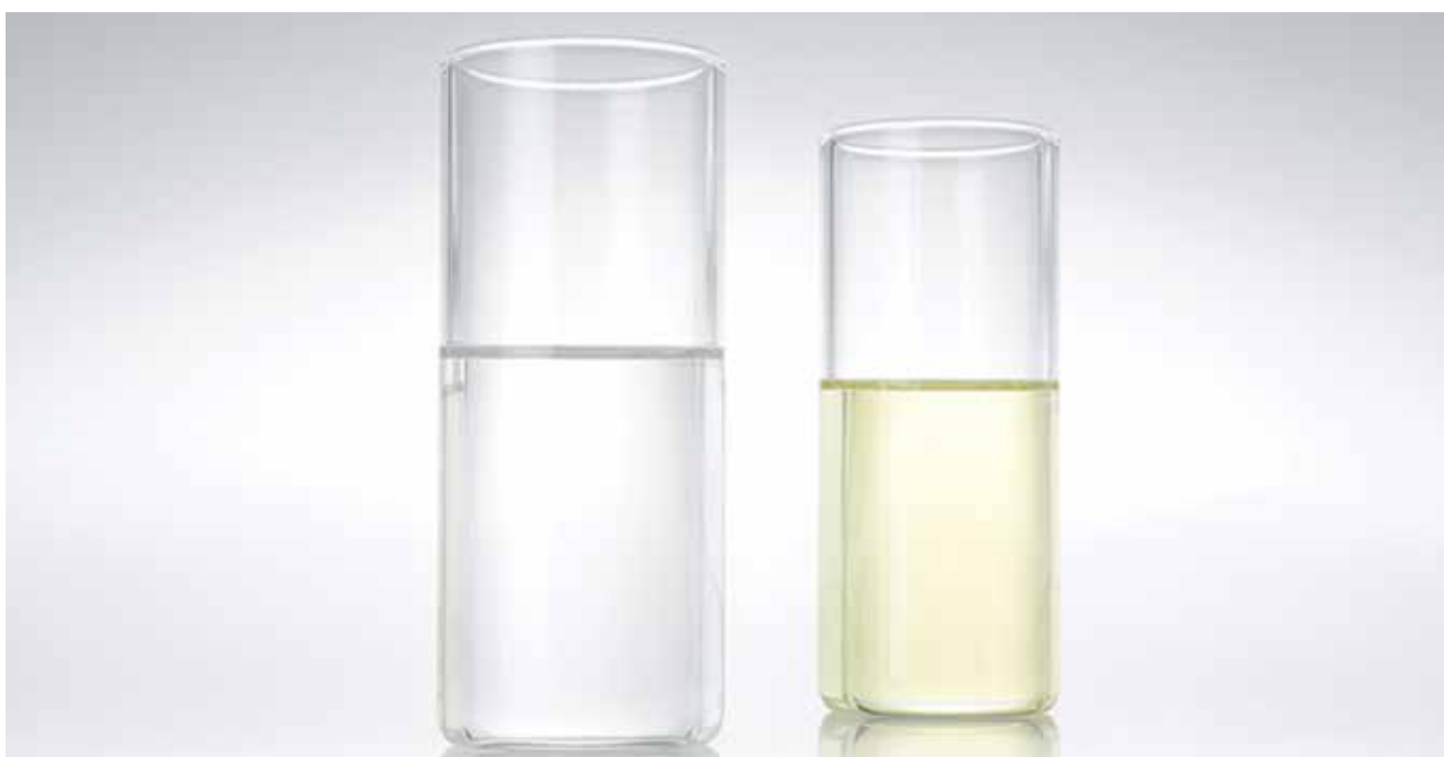
KLEURVERGEELIJING GTL (LINKS) EN DIESEL (RECHTS)
