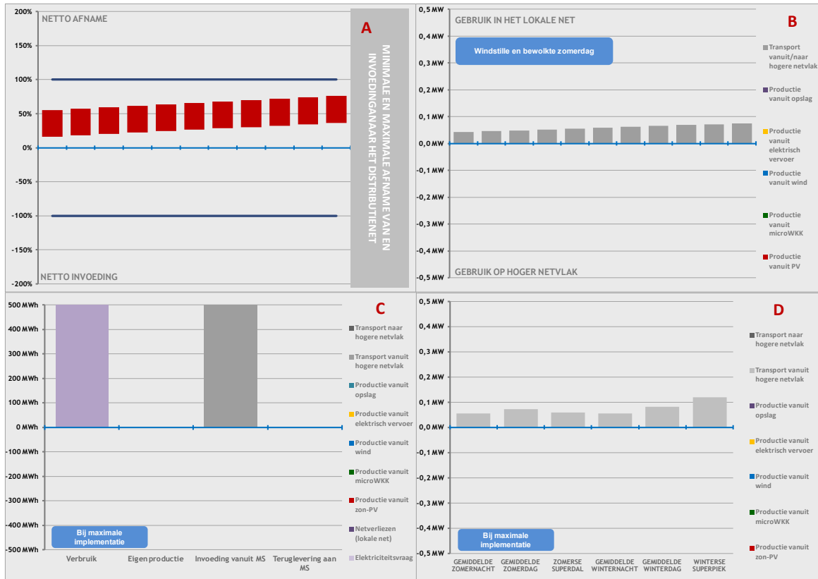
Figuur 22. Grafische weergave van de benutting van een laagspanningsnet met 100 huishoudens die alle overgaan op elektrisch vervoer (waarbij de auto's gemiddeld genomen continu worden geladen). Zie voor een nadere toelichting op de figuren pagina 83.
