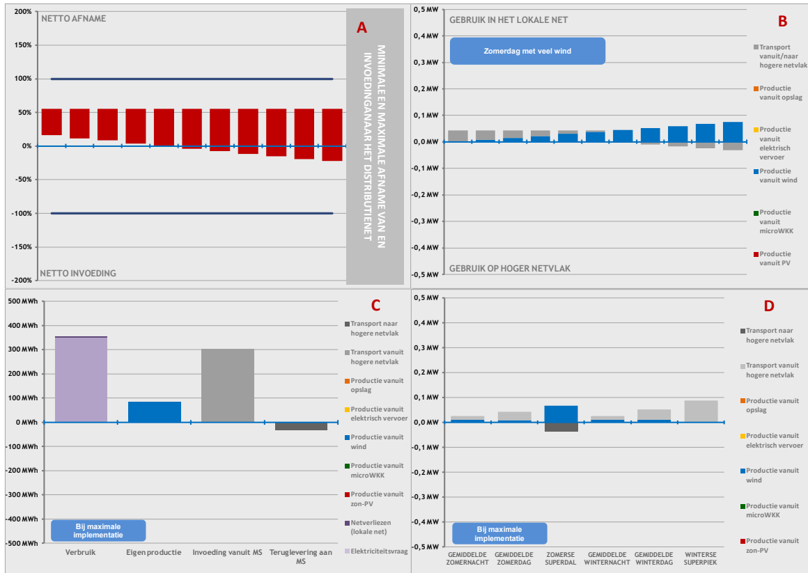
Figuur 12. Grafische weergave van de benutting van een laagspanningsnet met 100 huishoudens in een wijk waar 25 microwindturbines zijn neergezet. Zie voor een nadere toelichting op de figuren pagina 83.
