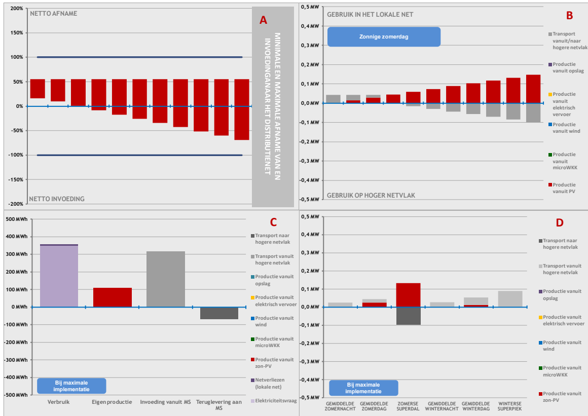
Figuur 8. Grafische weergave van de benutting van een laagspanningsnet met 100 huishoudens waarbij de huishoudens (in stappen van steeds 10 huishoudens) elk 10 m 2 zonnepanelen installeren. Zie voor een nadere toelichting op de figuren pagina 83.
