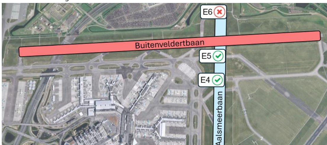
Figuur 6: Werkzaamheden aan Buitenveldertbaan zorgen voor een verkorte starten van de Aalsmeerbaan (de kop van de baan, E6, is niet beschikbaar voor startend verkeer)
