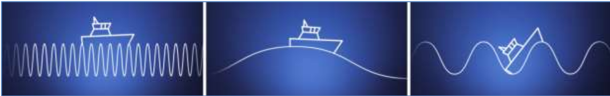
Figuur 19: Wanneer de lengte van de boot in de buurt van de golflengte zit, voelen de opvarenden de meeste impact. (plaatjes uit cursus)
