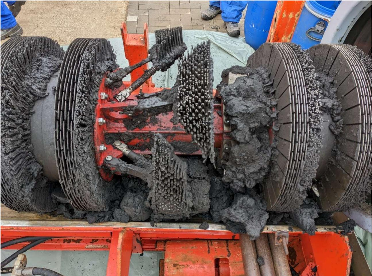
Abbildung 10: Ablagerungen aus einer Transportpipeline, zweite Reinigungsmolchung
