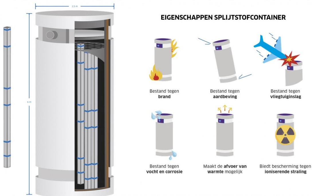
Figuur 26: Principe van droge opslag van verbruikte splijtstofelementen in Dual Purpose Casks (DPC) zoals voorzien in de SF 2 opslaginstallaties liii . De verpakking bestaat uit een metalen structuur die zo is ontworpen dat de restwarmte van de verbruikte splijtstof passief kan worden afgevoerd door interne geleiding, straling en natuurlijke convectie. De verpakking is gemaakt van metaal en andere materialen die bescherming bieden tegen ioniserende straling.
