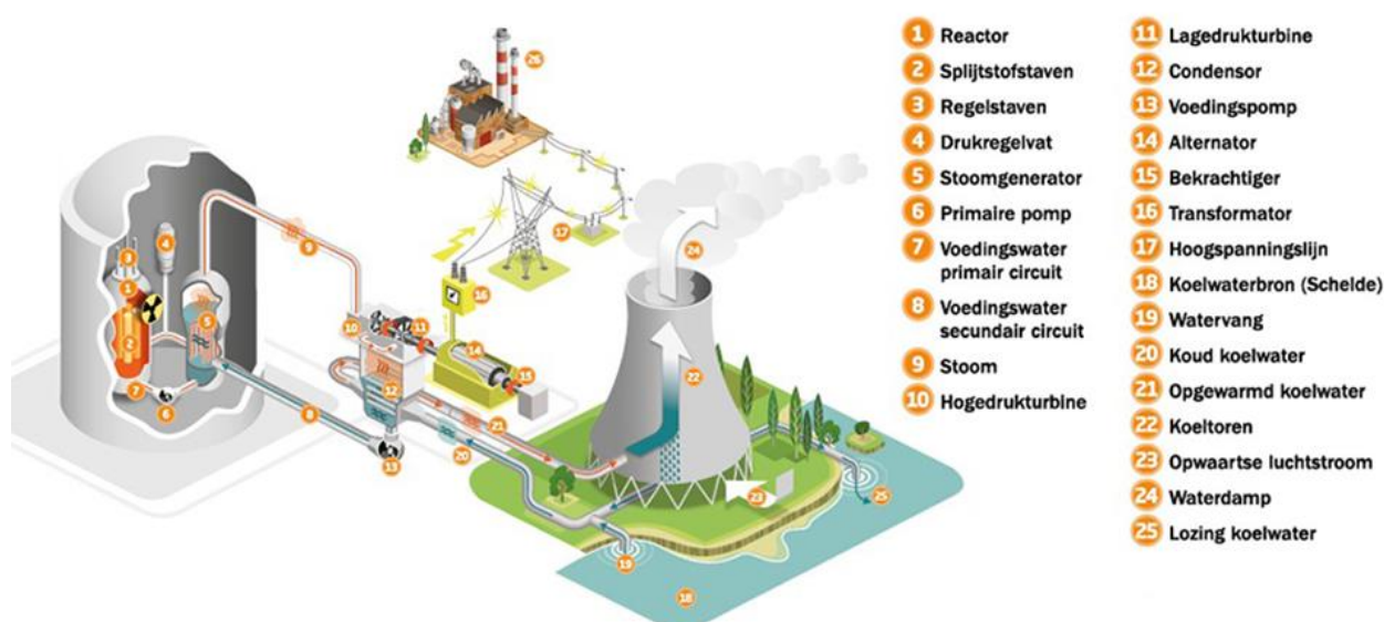
Figuur 2: Werking kerncentrale met van links naar rechts reactorgebouw, machinezaal en koelcircuit (Bron: Electrabel nv).
