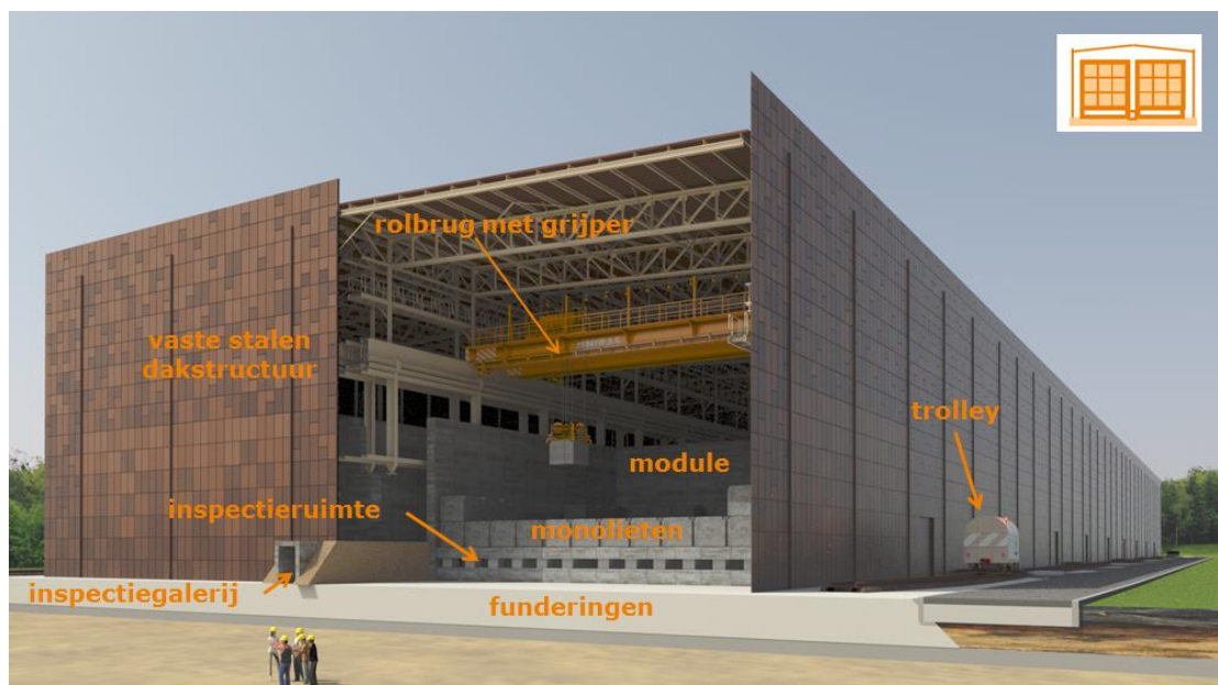
Figuur 28: Schets van de bergingsinstallatie voor categorie A afval tijdens de opvulling met monolieten lvii .
