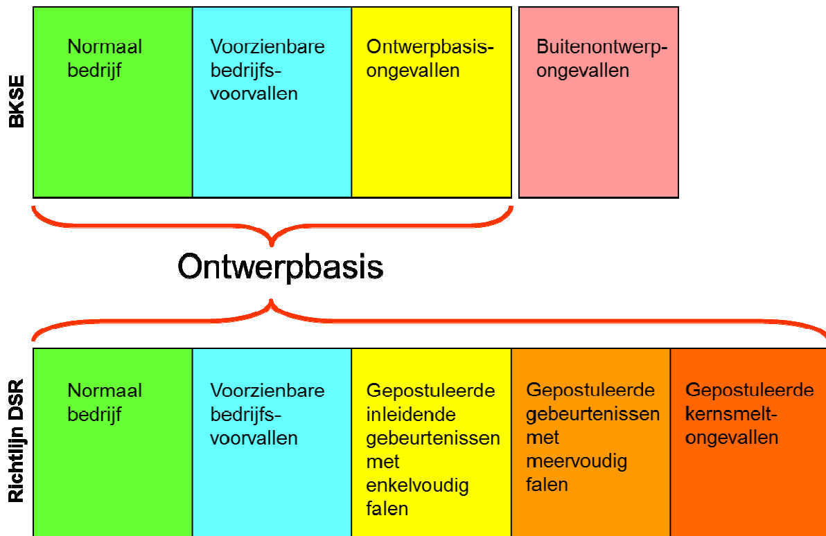
Figuur 1: Vereenvoudigde weergave van de ontwerpbasis volgens het Bkse en de Handreiking VOBK.
